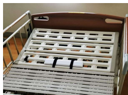
ベッドマットの下にセンサーを取付け
